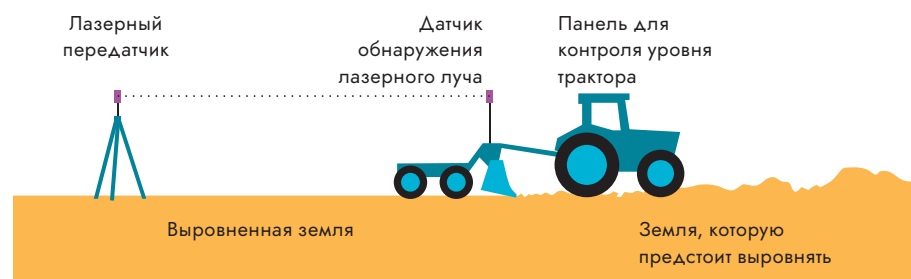
Рис. 3: Схематическое изображение лазерной планировки земель Источник: адаптировано из Cazanescu et al. 2010 [8]
